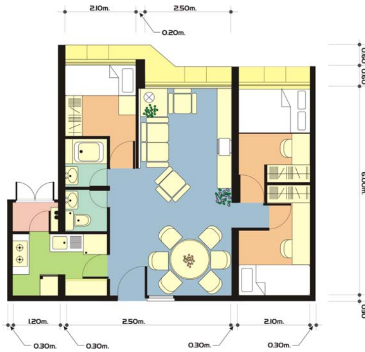
รูปที่ 10 ขนาดของห้องพักแบบ Three bedroom modular flat
