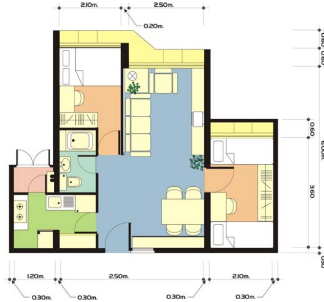
รูปที่ 9 ขนาดของห้องพักแบบ Two bedroom modular flat
