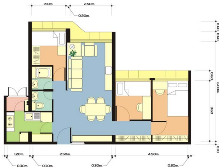
รูปที่ 11 ขนาดของห้องพักแบบ Three bedroom modular flat (ต่อ)
